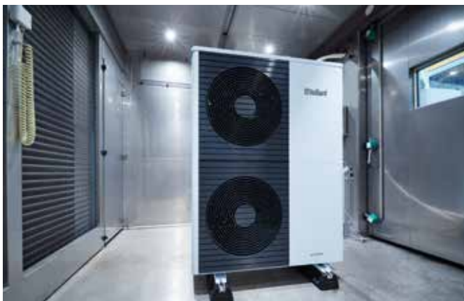
Testteams testen de buitenunit in de klimaatkamer.
