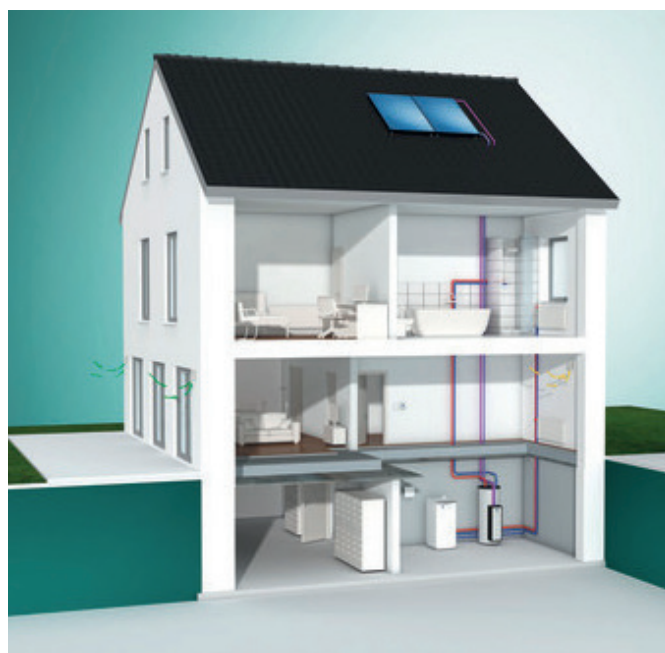
Chaudière sol à condensation au gaz ecoVIT, multiMATIC VRC 700, module internet VR 920, panneaux solaires thermiques auroTHERM, chauffe-eau solaire auroSTEP et pompe à chaleur air/air climaVAIR
