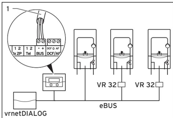
**Fig. 5.1 Connessione dell'accoppiatore bus (cascata)**
