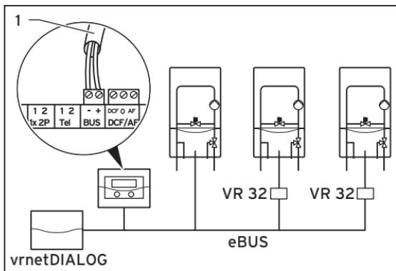
Abb. 5.1 Buskoppler anschließen (Kaskade)
