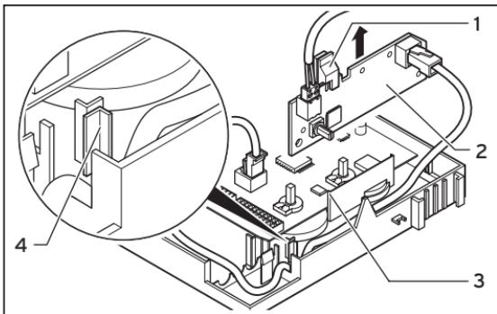
**Abb. 9.1 Buskopplerplatine ausbauen**
