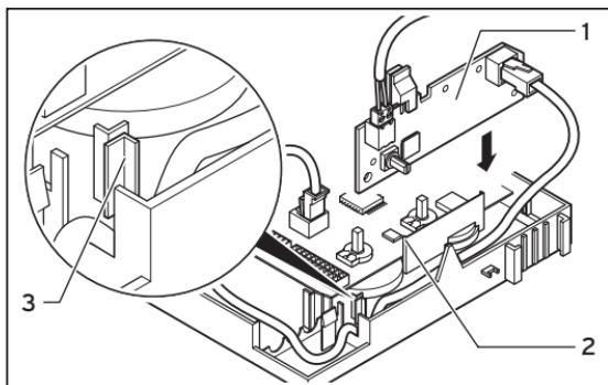
**Fig. 4.4 Montage de la platine du coupleur de bus**
