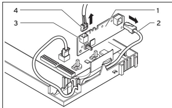
**Fig. 9.2 Smontaggio del cavo bus**
