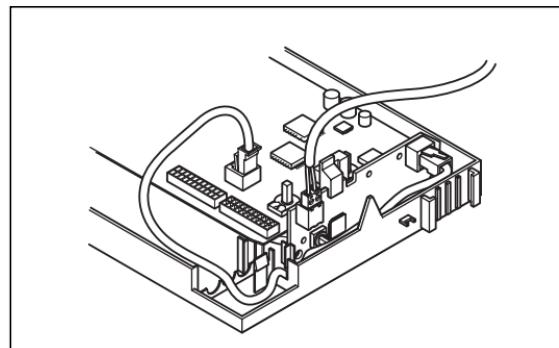
**Abb. 4.5 Buskopplerplatine eingebaut**
