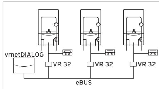
Abb. 5.2 Buskoppler anschließen (1 bis 16 Anlage)
