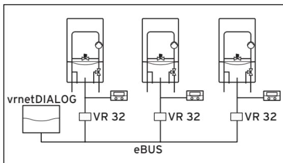
Fig. 5.2 Raccord du coupleur de bus (1 à 16 installations)
