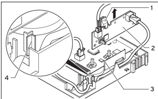
**Fig. 9.1 Smontaggio della scheda elettronica dell'accoppiatore bus**
