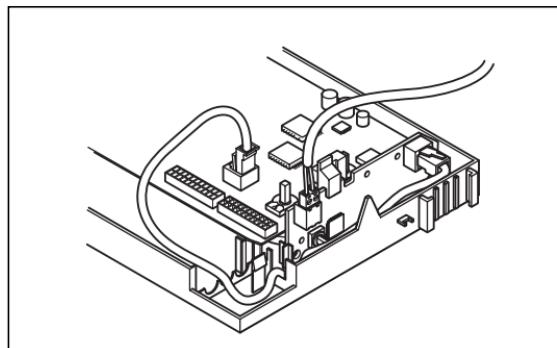
**Fig. 4.5 Scheda elettronica dell'accoppiatore bus montata**
