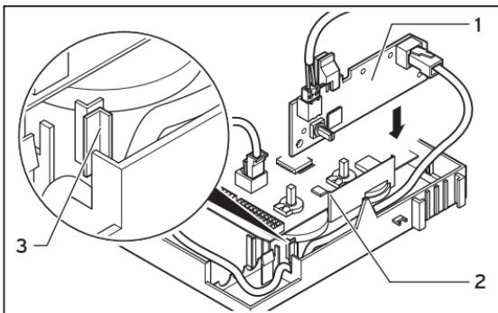
**Fig. 4.4 Montaggio della scheda elettronica dell'accoppiatore bus**
