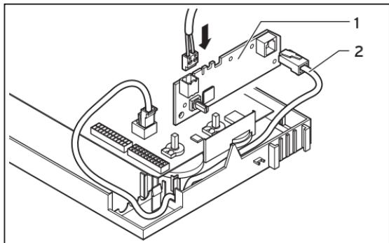
**Fig. 4.2 Montaggio della scheda elettronica dell'accoppiatore bus**
