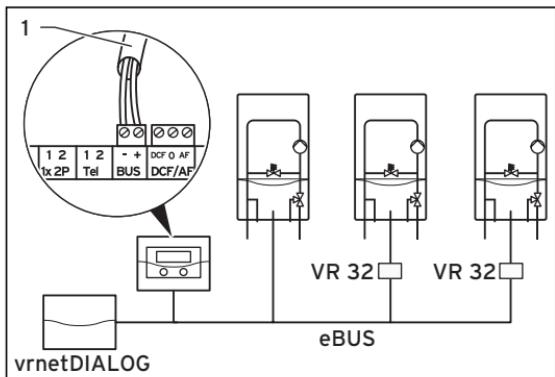
Fig. 5.1 Raccord du coupleur de bus (cascade)
