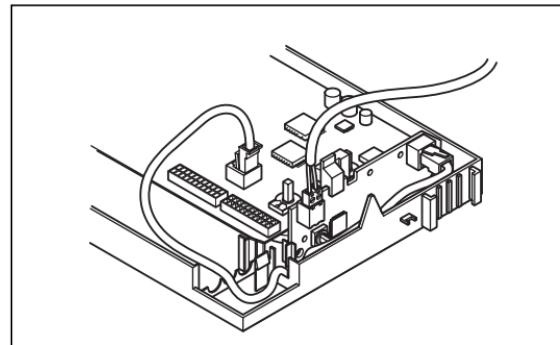
**Fig. 4.5 Platine du coupleur de bus montée**
