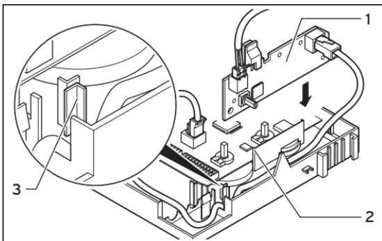
**Abb. 4.4 Buskopplerplatine einbauen**
