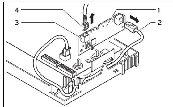
Fig. 9.2 Démontage du câble du bus
