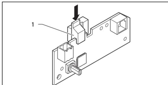
Afb. 4.3 Bevestigingsclip op de buskoppelingprintplaat monteren
