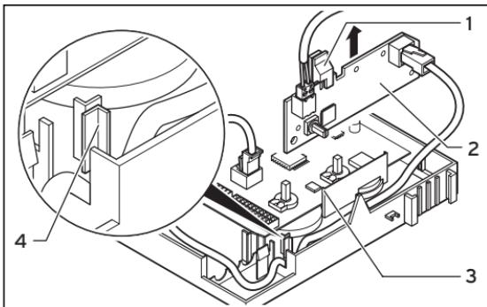
Fig. 9.1 Démontage de la platine du coupleur de bus
