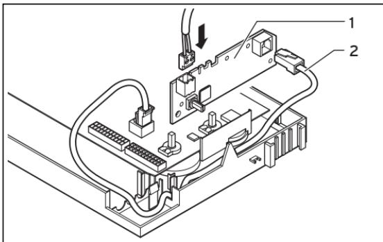
Abb. 4.2 Buskopplerplatine einbauen
