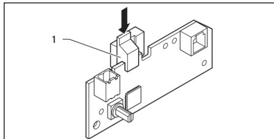
Abb. 4.3 Befestigungsclip an der Buskopplerplatine montieren
