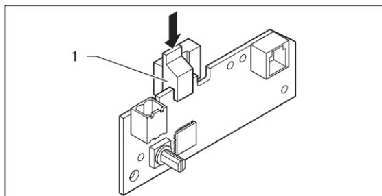
**Fig. 4.3 Montaggio della clip di fissaggio sulla scheda elettronica dell'accoppiatore bus**
