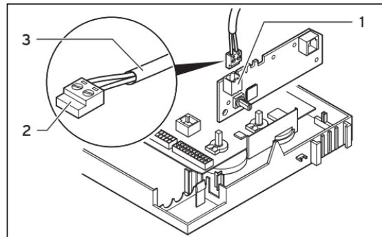
**Abb. 4.1 Busleitung an der Anschlussklemme im Heizgerät anschließen**
