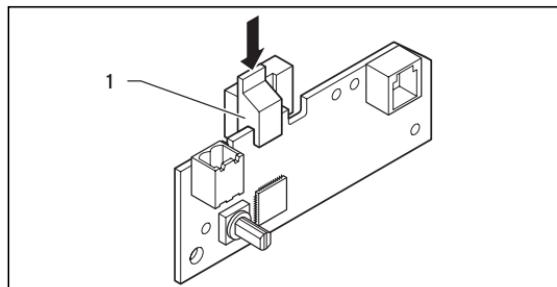
Fig. 4.3 Montage du clip de fixation sur la platine du coupleur de bus
