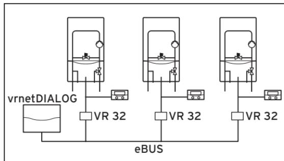
**Fig. 5.2 Connessione dell'accoppiatore bus (da 1 a 16 impianti)**
