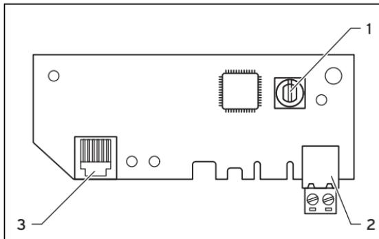
Fig. 3.1 Structure et raccordements du VR 32
