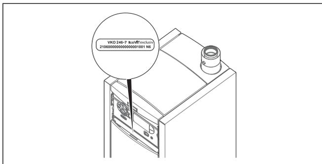
Fig. 0.1 Désignation de l'appareil et numéro de série
