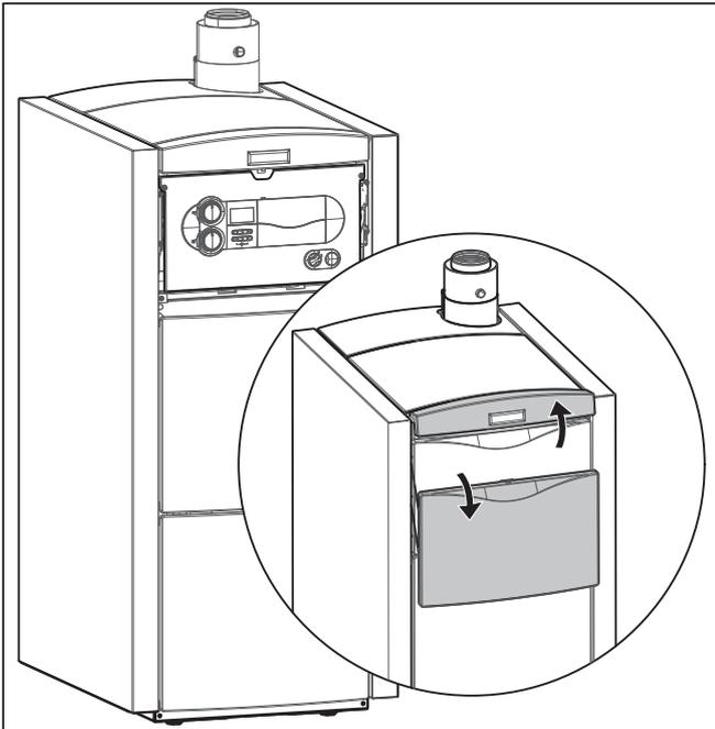
Fig. 6.1 Ouvrir le volet avant
