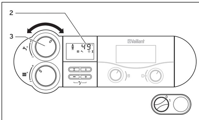
Fig. 6.6 Réglage de la température du ballon
