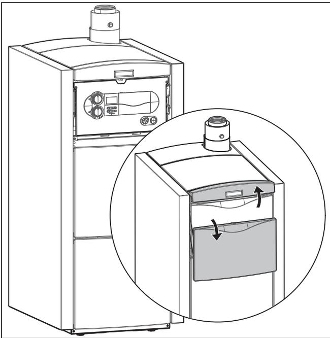
Abb. 6.1 Frontklappe öffnen
