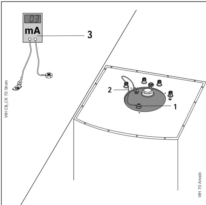
Fig. 6.1 Entretien de l'anode de protection
