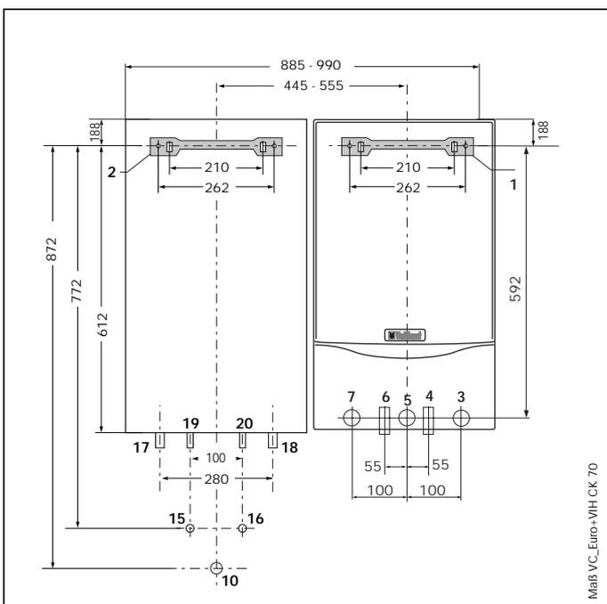
Fig. 4.2 Montage à côté d'une chaudière traditionnelle
