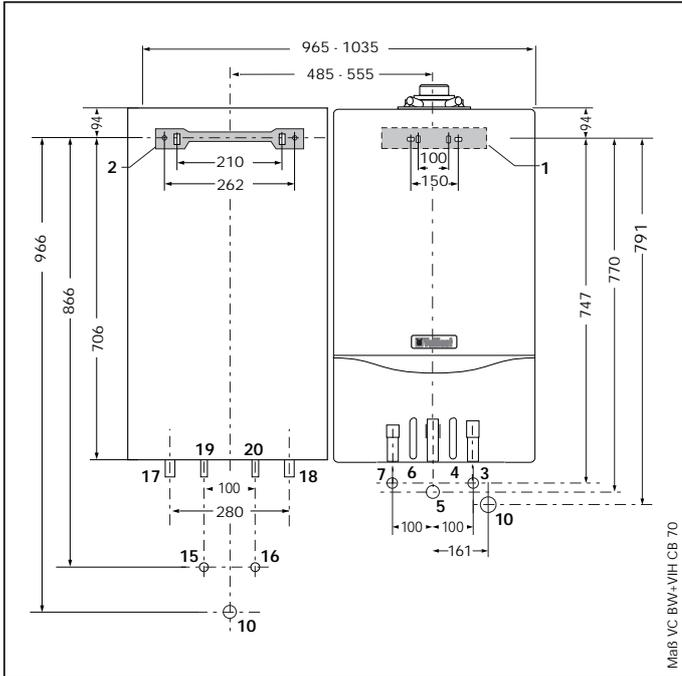
Fig. 4.1 Montage à côté d'une chaudière à condensation
