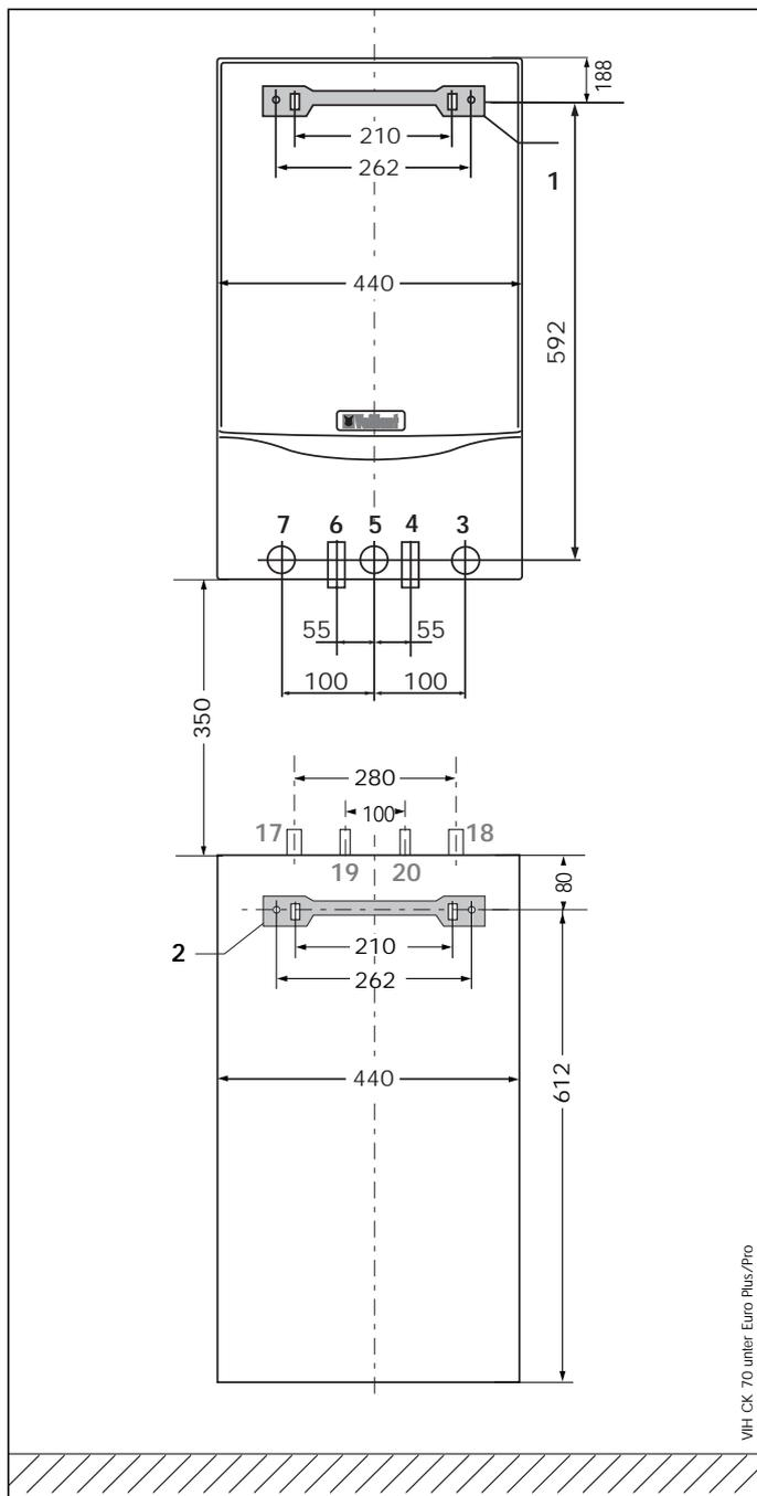
Fig. 4.4 Montage en dessous d'une chaudière traditionnelle
