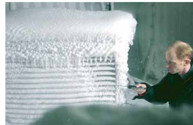
Dans la chambre climatique, les unités sont utilisées et testées dans des conditions météorologiques extrêmes.
