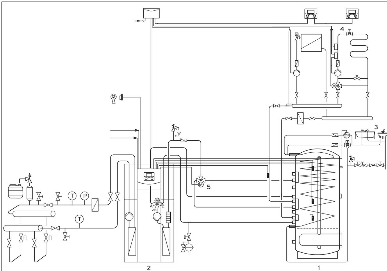
**Bild 2.1** Beredning av värmevatten och tappvarmvatten med värmepump
