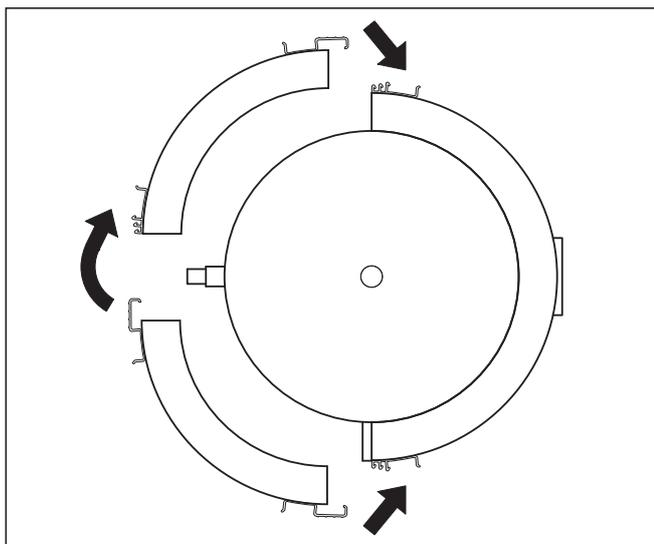
Fig. 4.5 Montage des coques d'isolation arrière
