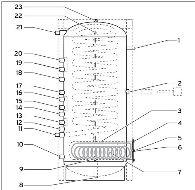
Abb. 2.4 Anschlüsse Verrohrung, Ansicht von links
