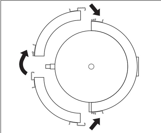
**Bild 4.5 Montera de bakre isoleringshöljerna**
