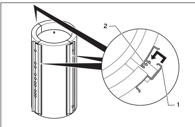
**Abb. 4.6 Klemmleisten einrasten**
