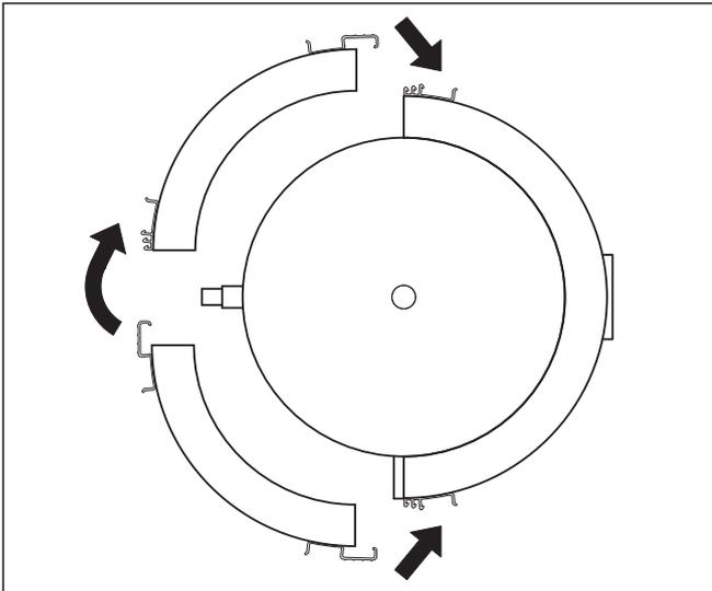
**Fig. 4.5 Påsætning af de bageste isoleringsindkapslinger**
