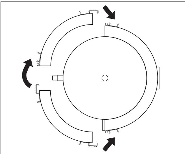
**Abb. 4.5 Hintere Isolierschalen aufstecken**
