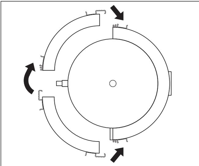
**Fig. 4.5 Inserimento delle guaine isolanti posteriori**
