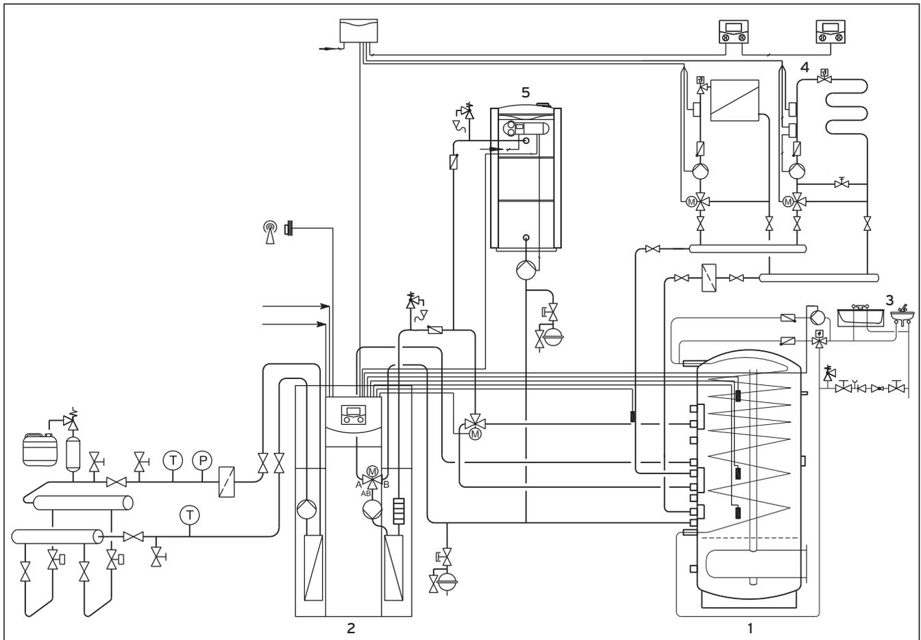
**Fig. 2.3** Varme og varmtvandsopvarmning med varmepumpe og oliekedel
