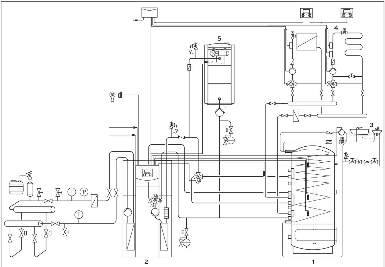
**Abb. 2.3 Heiz- und Warmwasserbereitung mit Wärmepumpe sowie Ölkessel**
