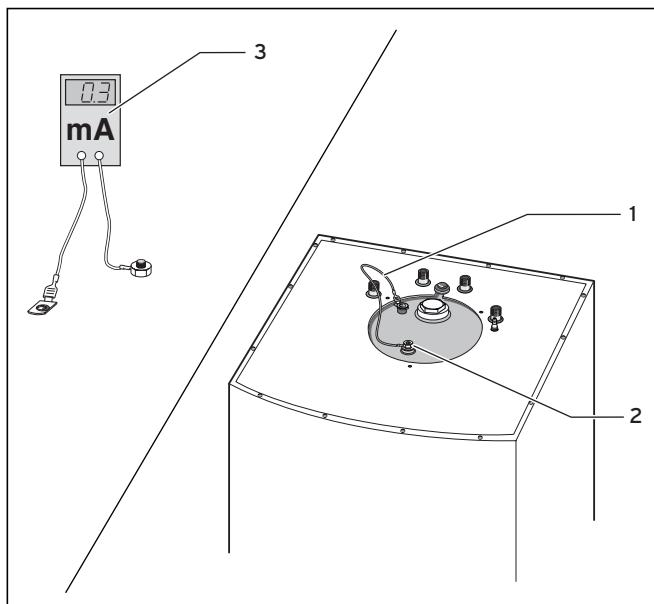
Fig. 7.1 Entretien de l'anode de protection en magnésium
