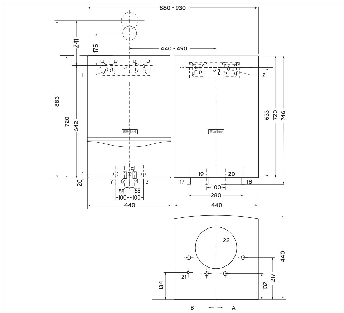
**Abb. 4.2 Abmessungen bei Montage neben dem Heizgerät**
