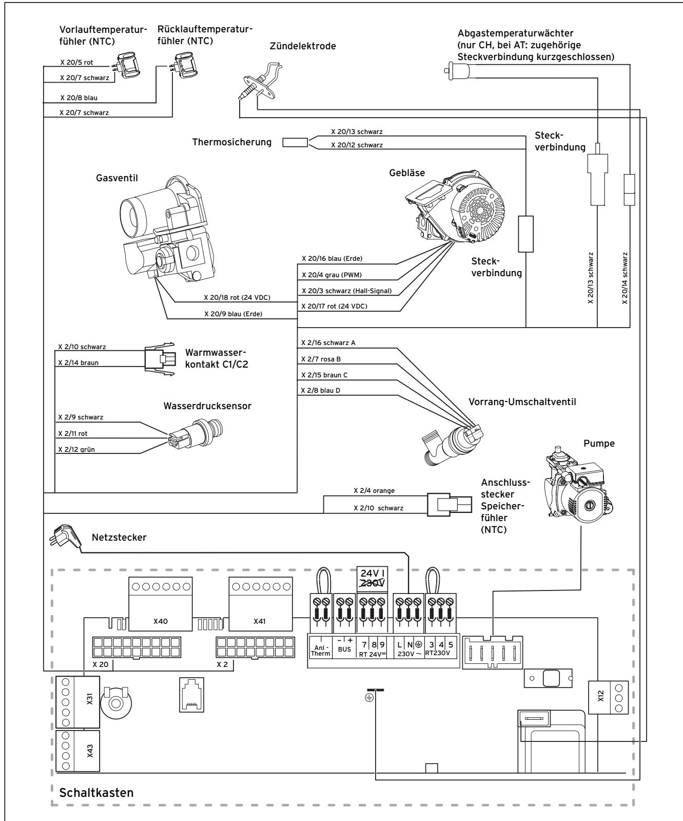
Abb. 5.1 Anschluss ans Heizgerät
