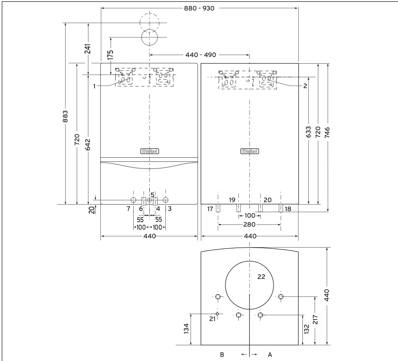
4.2. ábra Méretek a fűtőkészülék melletti felszerelés esetén
